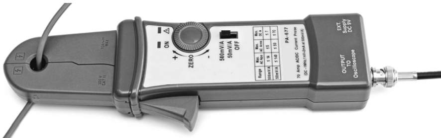
圖 2:連接到 PA-677 電流測試鉗
