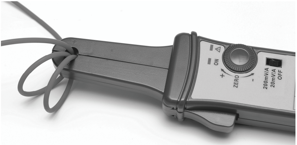
圖 4:提高電流靈敏度方式
