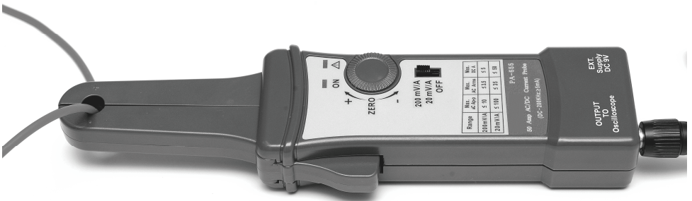
圖 2:連接到 PA-659 電流測試鉗
