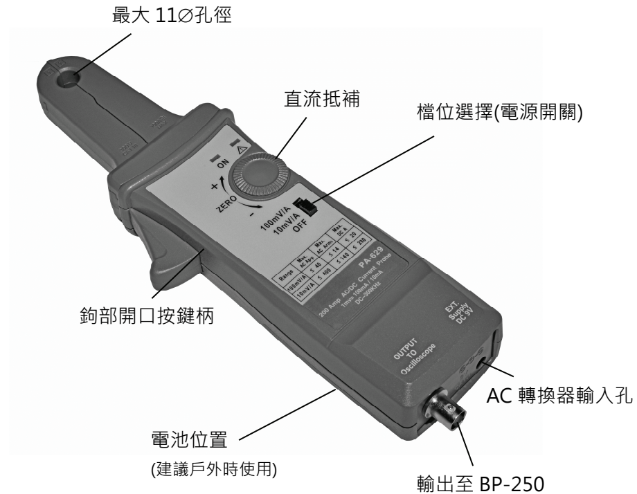
圖 1: PA-629 電流探測鉗上的控制及指示。
