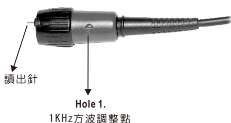
正確調整1 KHz 方波的示意圖
